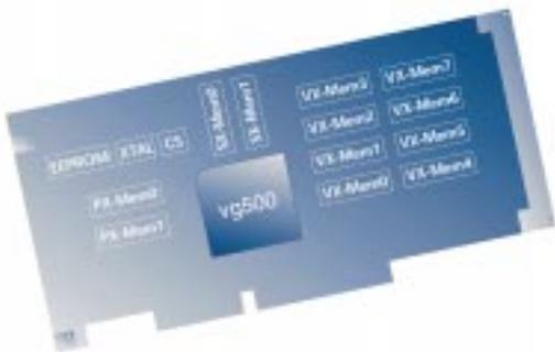
Die VolumePro PCI Karte besteht aus einem einzigen Board mit einer 32-bit 66 MHz PCI Schnittstelle. Das Board enthält einen vg500 Volumerendering ASIC, zwanzig 64 Mbit SDRAM mit 16-bittigen Datenpfaden, ein serielles EEPROM und eine Taktgenerierungsschaltung.
