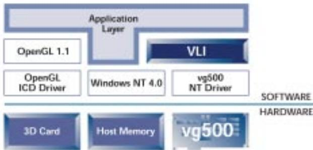
Die VLI API ist ein Satz von C++ Klassen, welche den vollumfänglichen Zugriff auf die Features des vg500 Chips ermöglichen. VLI ersetzt keine vorhandenen API's. VLI arbeitet mit der 3D Graphik Library, wie zum Beispiel der OpenGL, zusammen, um das Rendern der Volumen und die Darstellung des Resultates in einer 3D Szene zu ermöglichen.
